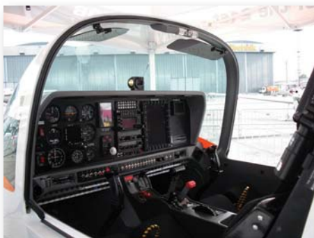
Индонезанско ваздухопловство инсистирало је да њихови авиони G 120 TP буду опремљени класичним аналогним кабинским просторима (С. Влачић)
