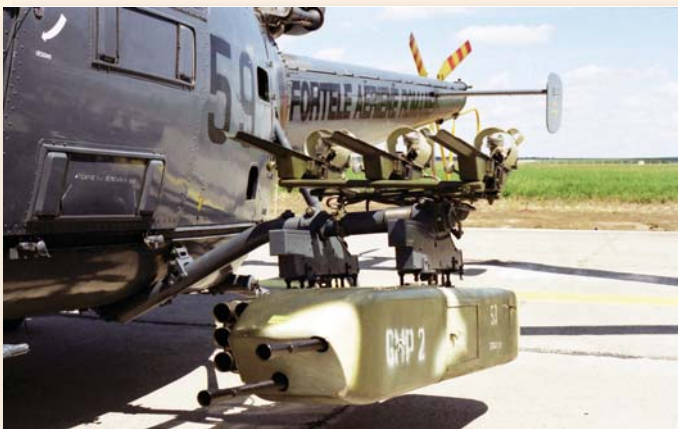
Бочни носач наоружања на румунском IAR-316B са лансирним шинама за штри „маљутке“, контејнером са два митраљеза 7,62 mm и лансером за шест невођених ракетних зрна (Александар Рагић)
