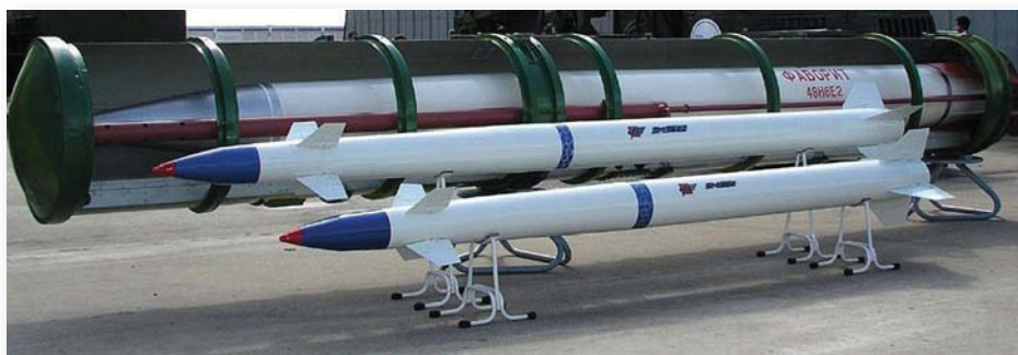
Ракете 9M96E и нешто већа E2, које се користе на системима „витјаз” и С400
